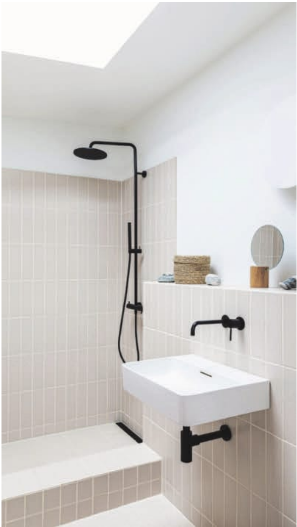
Fliserne på badeværelset er lavet af restproduktionen fra et firma, som producerer tegl. De er valgt i en lys beige-rosa farve, som giver associationer til stranden foran grunden. Den høje kant til brusenichen gør badeforhæng overflødigt, ligesom den indbyggede hylde også er et møbel i sig selv og minimerer behovet for at tilføre ekstra elementer til rummet.
